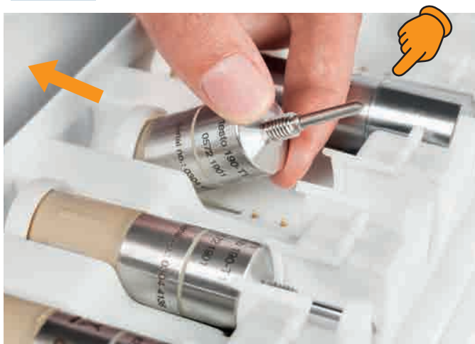
ソケット下部をスライドさせ簡単設置
