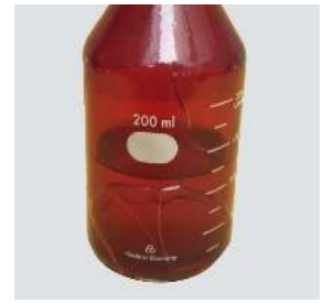
約70cmの高さから コンクリート面に3回落下後
