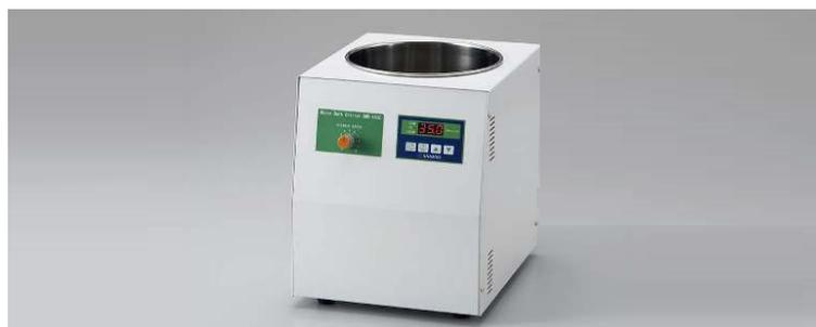
ステンレススノコ標準付属。水槽内、試料を同時に加熱・攪拌ができます。SVスタートのタイマー運転機能も搭載。
