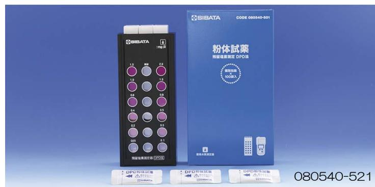
残留塩素を含む水にDPD試薬を加えたとき特異的に反応し、残留塩素の量に応じて淡赤紫色を呈する反応に基づく方法で測定できます。
