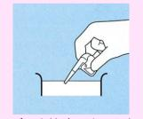
ノズルを検液の中に入れて、ゆっくりと指の抑えを 緩めながら、検液をポンプ 部に吸入します。
