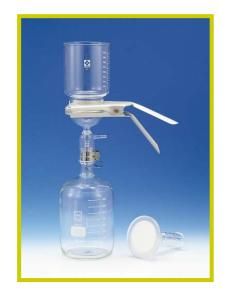
フィルター適応サイズは Ф25・47・90mm用の3種類 よりお選び頂けます
