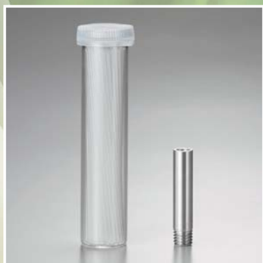
左：融点測定用毛細管 右：温度計サポート
