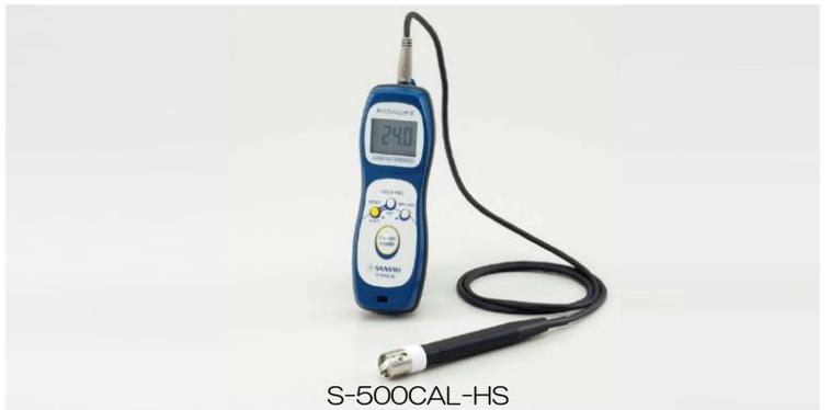
K熱電対採用のハンディ温度計 (T熱電対も使用可能)。キャリブレーション機能搭載で、温度ポイント1点で器差補正が可能。防水規格IPX6準拠。表面センサは応答速度約3秒と速い応答性。
